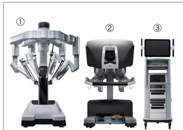
ダビンチは大きく分けて3つの機械で構成されています。手術では①患者さんの体内に挿入し、外科医が②サージョンコンソールに座り、モニターで確認しながら遠隔操作で手術を行います。手術をサポートするスタッフは③ビジョンカートのモニターで手術の様子を確認することができます。
