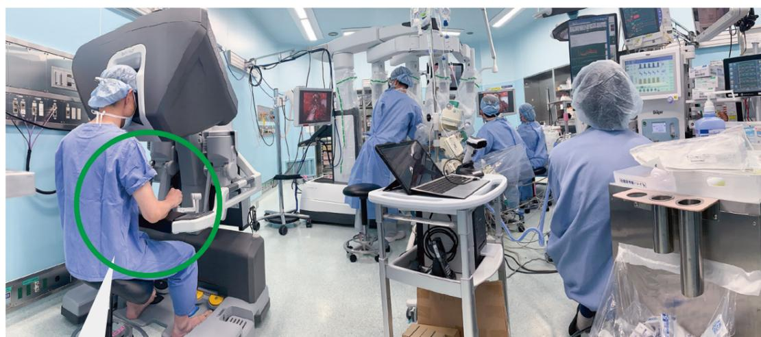
外科医がサージョンコンソールと呼ばれる操作機器に腰掛け、モニター画面を見ながら両手両足を使い、4本のロボットアームを自在に操る
