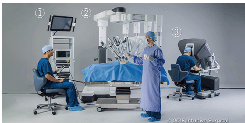
手術支援ロボット「ダビンチ」は、3つの機械で構成されています。 ①ビジョンカート：手術チームスタッフが手術状況を確認します ②パシエントカート：カメラと3本のアームからなり、患者さんの胸の中に挿入します ③サージョンコンソール：外科医がロボットを操作します
